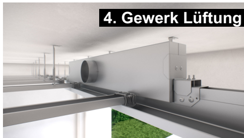
Lüftungskasten von oben einstecken und in wenigen Sekunden seitlich arretieren. Danach Zuluftschlauch anbringen.
